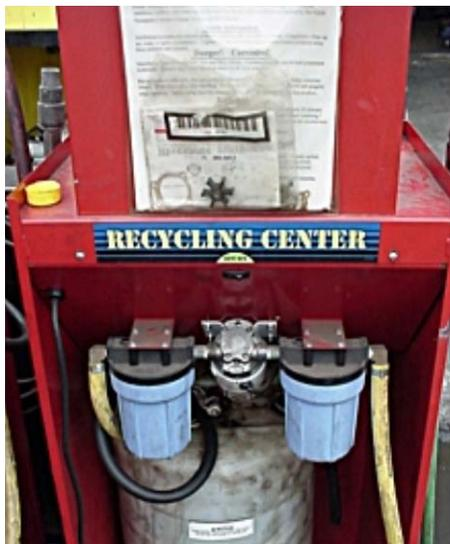
Figure 2 – Système type de recyclage d'antigels
