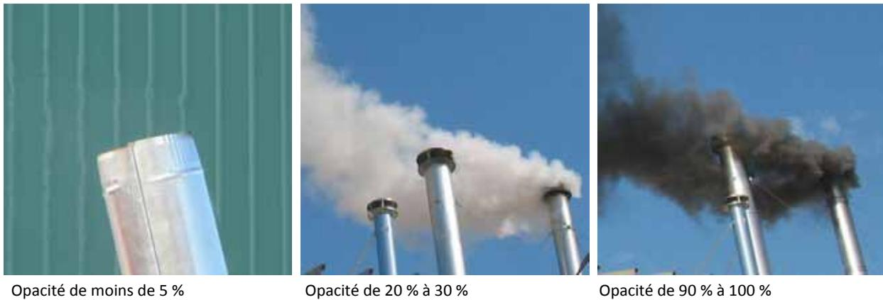
**Figure 6 - Exemples de niveaux d'opacité de la fumée**
