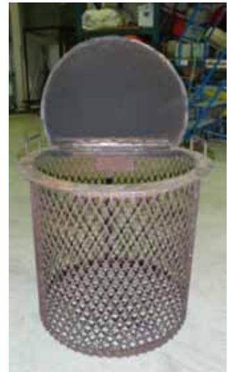
Un panier métallique ou une grille relève les déchets en combustion et facilite leur mélange avec l'air entrant. Ce panier amovible facilite aussi l'accès aux cendres non consommées qui pourraient s'être accumulées au fond du baril.
